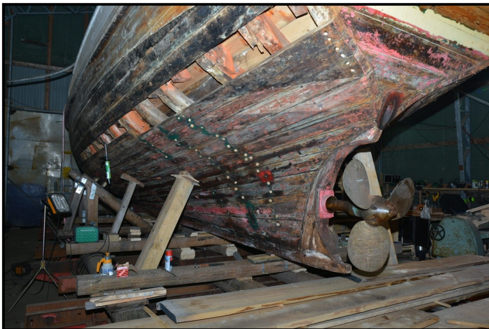
Snart ferdig å kontrollere spiker, vi har også revet hud for å kontrollere spant
