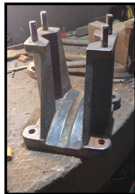
etter 5 års lagring ,og mange år på dekke ser kjettingsakse- ne ut som dette
