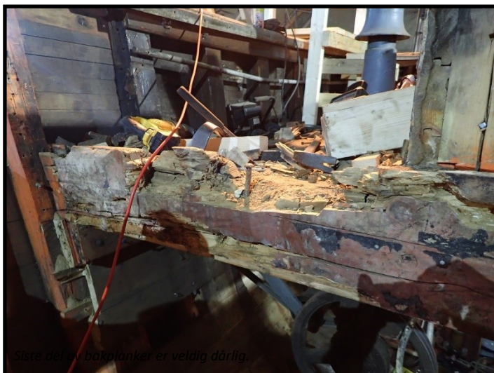
Bakkplank er dårlig på styrbor side
