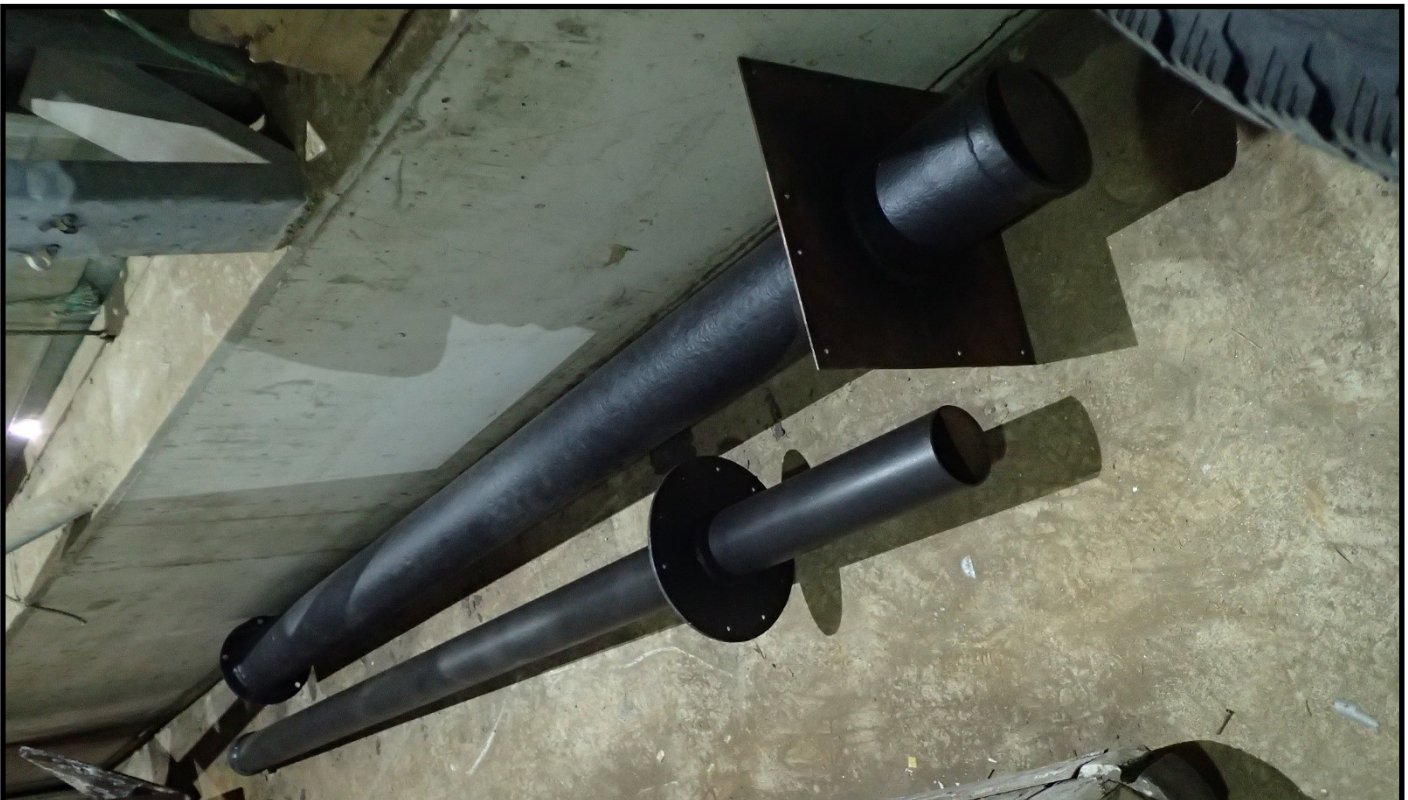
malt med varmebestandig maling
