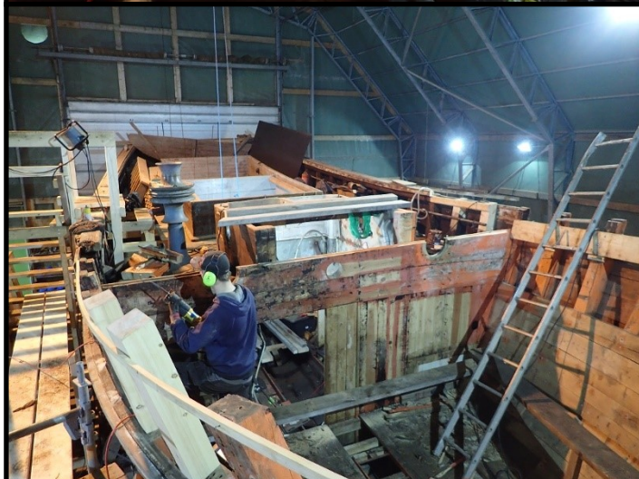
Stor del av bakkplanken er veldig dårlig.
