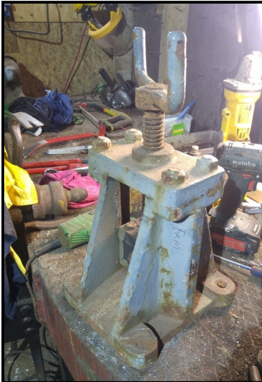
etter 5 års lagring ,og mange år på dekke ser kjettingsakse- ne ut som dette
