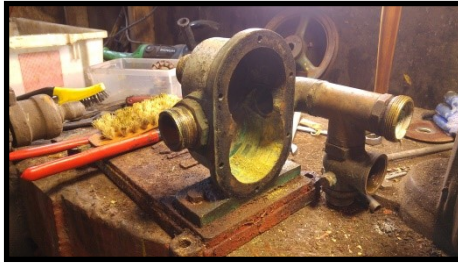
Pump huset er i godt standt
