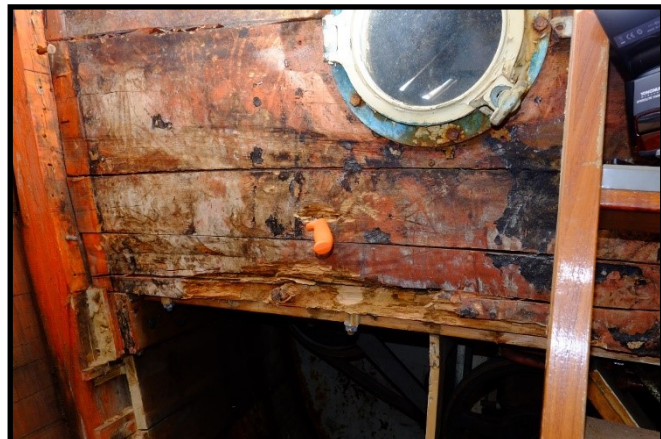
Bakkplank er dårlig på styrbor side
